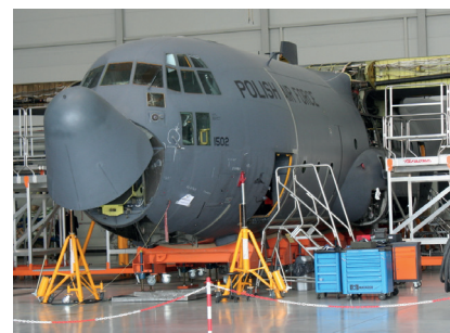
Największy hangar remontowy WZL-2 w Bydgoszczy, w którym można prowadzić prace remontowe m.in. polskich Herculesów. Na zdjęciu C-130E nr takt. 1502 podczas prac remontowych
